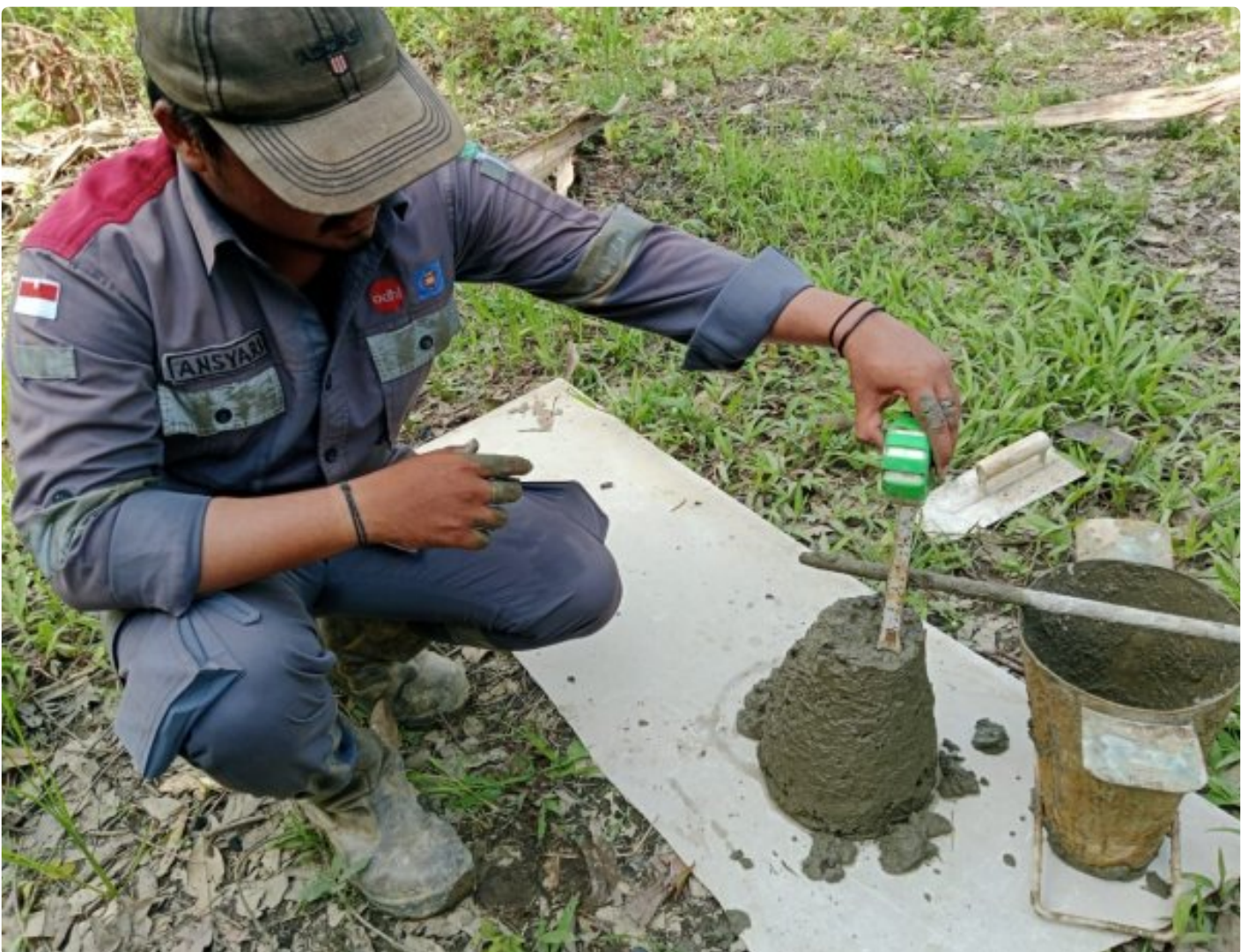
Uji Slump Beton Sasaran Jalan TMMMD ke-116 Kodim 1002/HST Oleh Dinas PU dan Konsultan
